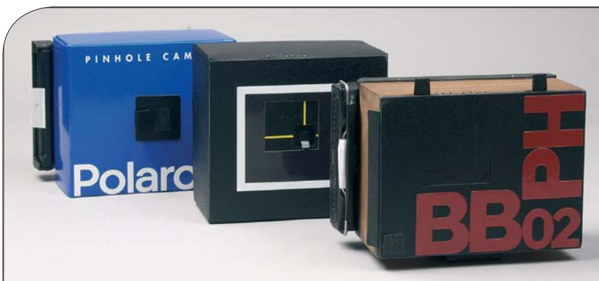
Le fotocamere a foro stenopeico usate da Beppe Bolchi: dalla Polaroid Pinhole Photo Kit alla fotocamera BB01 PinHole autocostruita, fino alla BB02 PinHole in legno.
